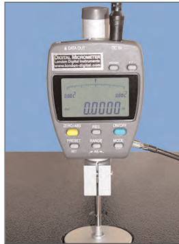
Micrómetro digital con precisión hasta .001mm/.0001"
