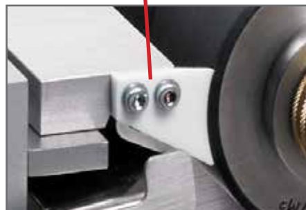
Rasqueta forma la cámara para el depósito de la tinta
